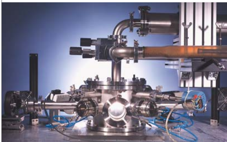
Dipositif de laboratoire pour la synthèse de nanopoudres utilisant la technologie de pyrolyse laser.
