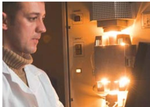
Essai de dilatométrie de **trempe** effectué sur un échantillon de gaine soumis à des conditions dynamiques de chauffage puis refroidissement (jusqu'à 100 °C/s).
