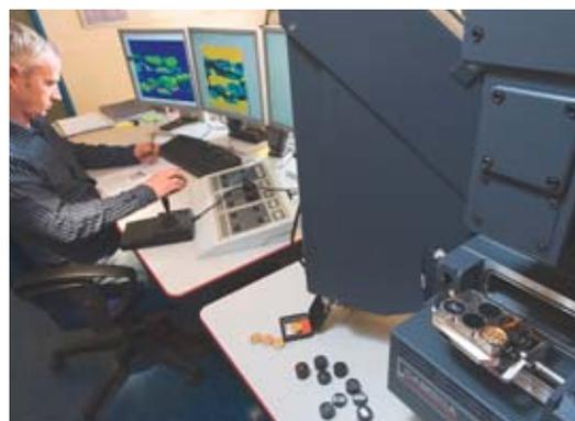
Vue d'ensemble de la microsonde électronique de Castaing qui permet notamment de quantifier à l'échelle micrométrique la répartition des éléments d'addition et des impuretés au sein des gaines de combustible.
