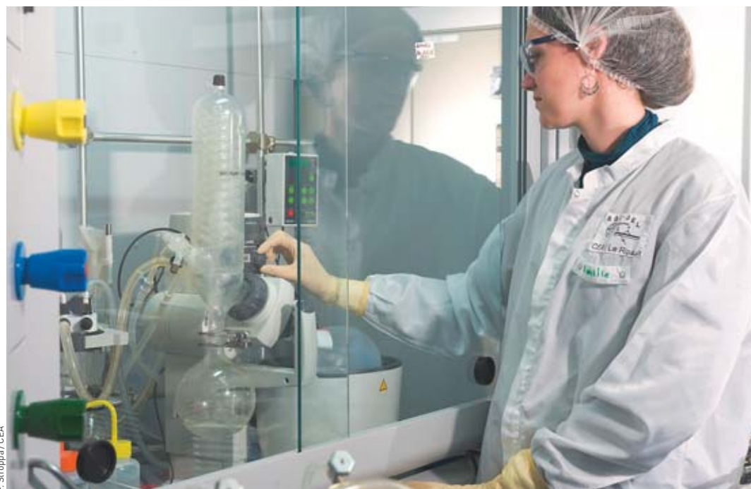
Opératrice préparant la synthèse de nanoparticules, sous hotte, par le procédé Sol-Gel, dans un évaporateur rotatif.
