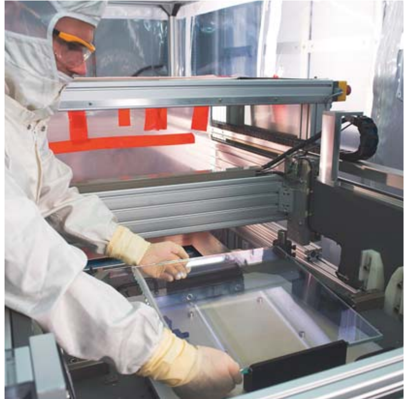
Mise en place d'un substrat pour traitement optique par enduction laminaire.
