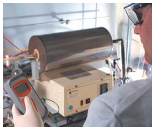
Synthèse expérimentale des nanotubes de carbone par CVD (pour Chemical Vapor Deposition ).
