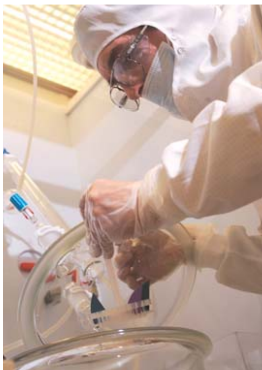
Technicien en salle blanche intervenant sur un réacteur chimique dédié à la silanisation collective des wafers silicium ou des lames de verre pour la préparation des puces à ADN ou des laboratoires sur puces.
