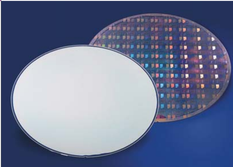
Tranches de germanium sur isolant (GeOI). Substrat réalisé par le procédé Smart cut™ (en bas) et tranche avec puce (en haut).
