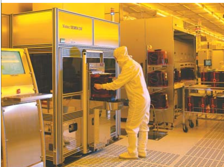
Opérateur chargeant la machine d'exposition par faisceau d'électrons. Cette machine permet de réaliser des motifs inférieurs à 11 nm sur les tranches de silicium de 300 mm de diamètre.
