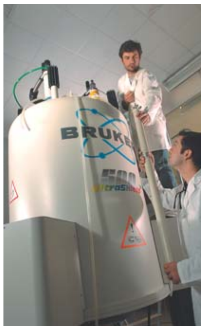
Aimant du spectromètre RMN du solide à haut champ magnétique utilisé pour étudier la structure des matériaux. La fréquence de résonance du noyau d'hydrogène, c'est-à-dire du proton, est de 500 MHz dans cet aimant.
