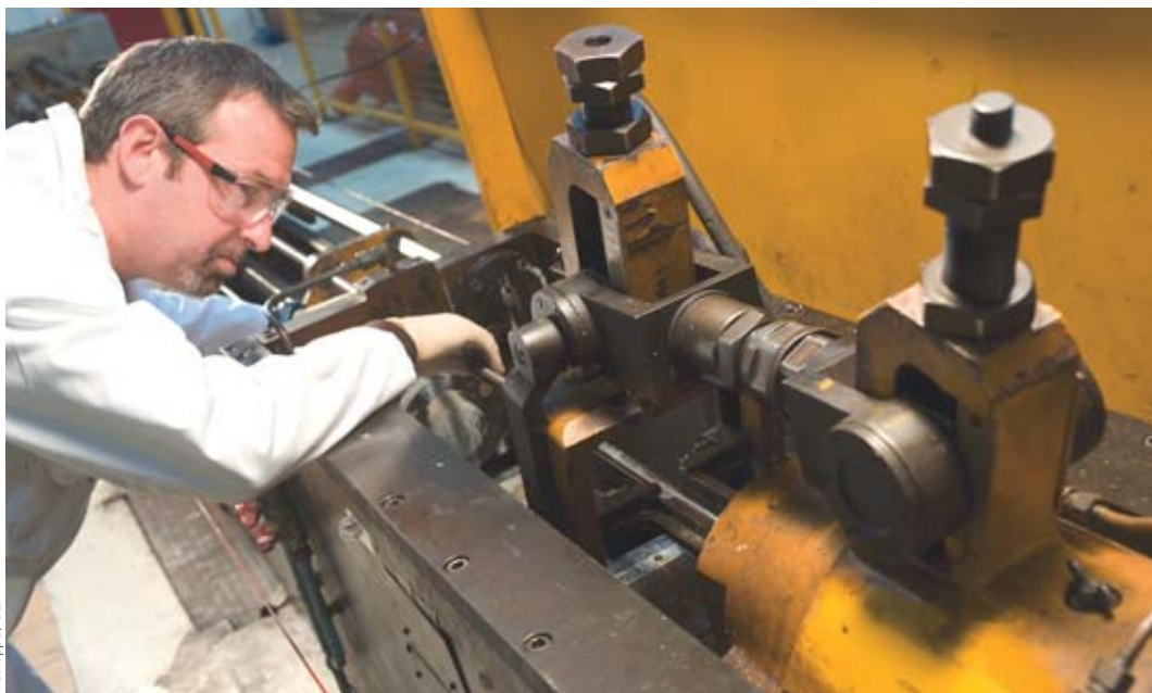
L'étape de laminage à froid des tubes en alliage ODS vise à mettre en forme l'ébauche filée pour obtenir des tubes fins à la géométrie choisie.
