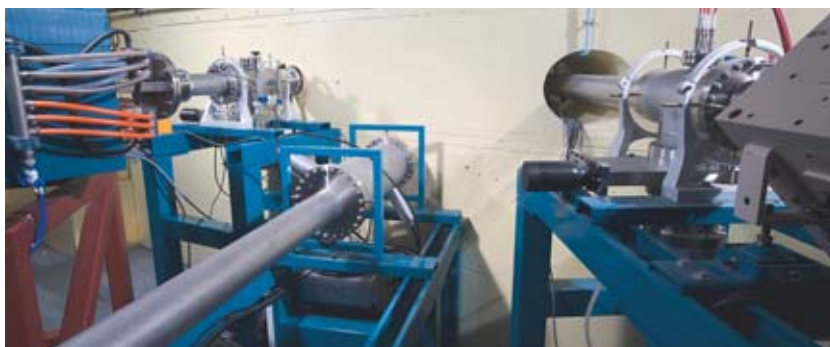
Lignes de faisceau de Japet (à gauche), d'Yvette (au centre) et d'Épiméthée (à droite) convergeant vers la chambre d'expériences triple-faisceau localisée derrière le mur.
