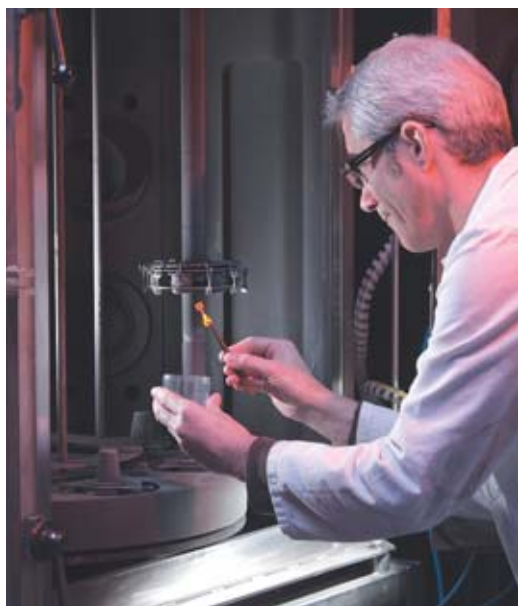
Chambre de dépôt du réacteur d'évaporation par arc cathodique sous vide, comportant un porte-subsstrats pouvant se déplacer suivant trois axes de rotation.
