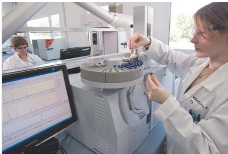
Chromatographe gazeux couplé à un **spectromètre de masse** (GC-MS) pour le suivi des synthèses des greffons organiques fonctionnels.
