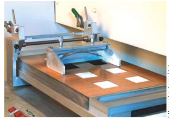
Banc d'enduction des couches actives des piles PEMFC. Membrane en cours de recouvrement par une encre constituée de carbone platiné et d'électrolyte.
