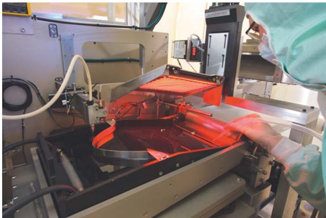
Plateforme D2M, machine de dépôt ordonné de micro ou nanoparticules opérant sur des substrats de petite ou grande dimension [de quelques cm 2 à quelques centaines de cm 2 ].
