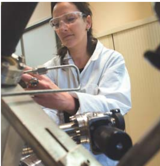
Croissance du diamant dans un réacteur de dépôt en phase vapeur (CVD/Chemical Vapor Deposition) assistée par plasma micro-ondes.
