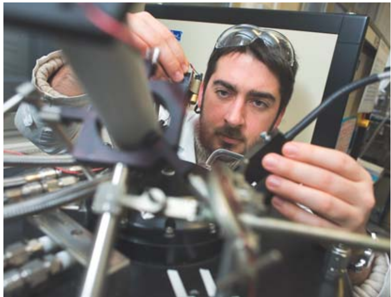
Mesure in situ de l'épaisseur synthétisée du diamant durant le dépôt.
