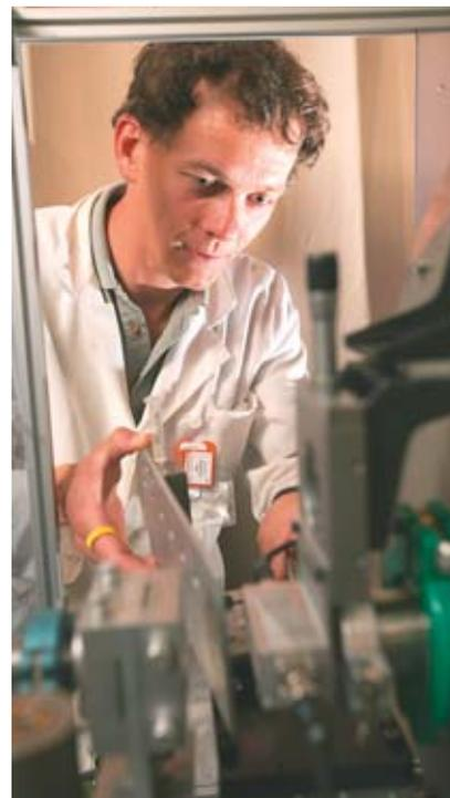
Utilisation d'un appareil de diffusion des rayons X, aux petits angles, permettant de caractériser la taille, la forme et la concentration de nanoparticules.
