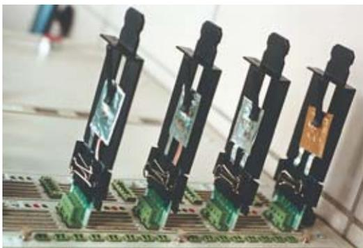
Bancs de cyclage des systèmes au lithium allant de la pile bouton à la mini-batterie. Les piles bouton sont utilisées pour les tests de matériaux, les éléments plats sont les prototypes de mini-batteries lithium-polymère, à intégrer dans les cartes à puce.
