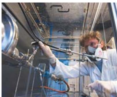
Préparation d'une expérience permettant de tester l'imperméabilité, les équipements de protection individuelle (masques et gants) aux nanoparticules dans le cadre du projet européen Nanosafe.
