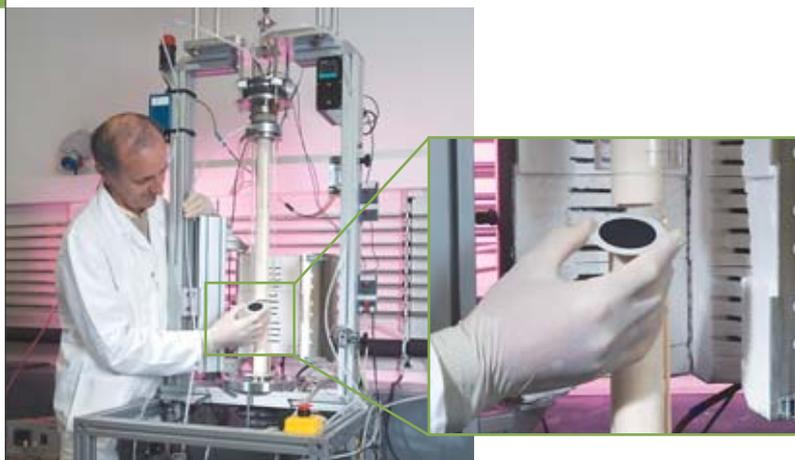
Montage d'une cellule d'électrolyseur de l'eau à haute température (EHT) dans un banc de test permettant de déterminer sa performance et sa durabilité.
