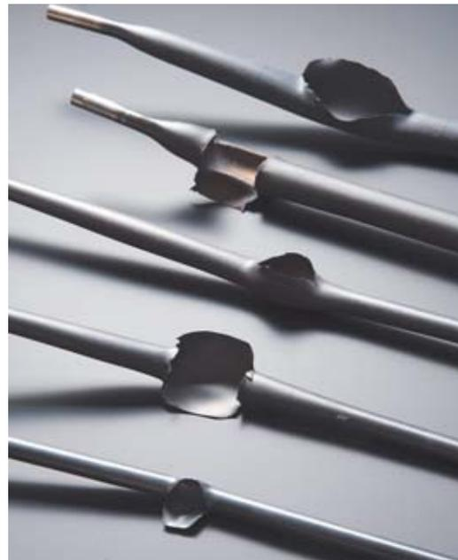
Échantillons de gaines ayant subi des tests d'éclatement en conditions accidentelles à haute température dans l'installation « EDGAR ».
