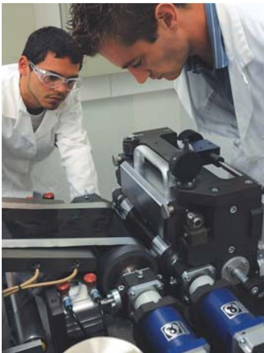
Induction d'électrode sur petit banc pilote.
