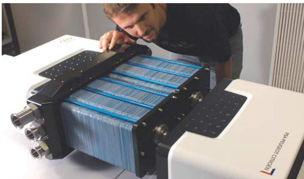
Pile à combustible Genepac (pour générateur électrique à pile à combustible) développée par le CEA, en partenariat avec Peugeot-PSA, pour une prochaine utilisation dans l'automobile.
