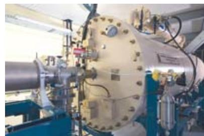
Accélérateur Pelletron™ tandem Japet. Sa source délivre des faisceaux d'ions d'éléments électronégatifs tels que le chlore ou l'iode, ou encore des faisceaux d'ions métalliques comme le silicium ou l'or.
