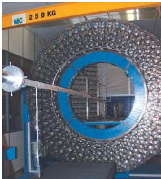
Machine de tressage permettant la réalisation de tresses tridirectionnelles.
