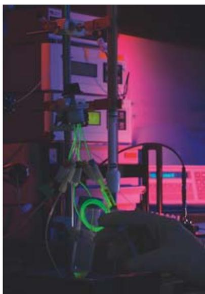
Colonne de sol de petites dimensions permettant d'étudier la migration de nanoparticules en utilisant des nanotraceurs fluorescents.
