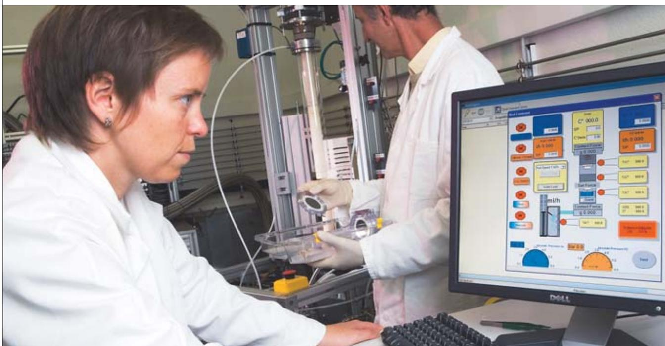
Test électrochimique d'une cellule d'électrolyseur EHT fonctionnant à 800 °C : mesure des performances en tension et en courant de la cellule avec évaluation de la quantité d'hydrogène produite.
