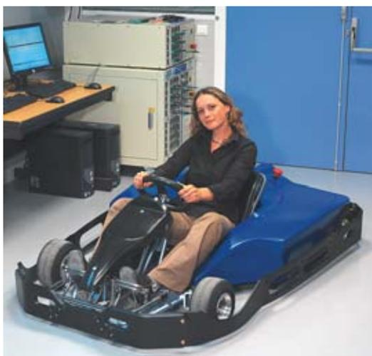
Prototypage de kart alimenté par batterie au lithium.
