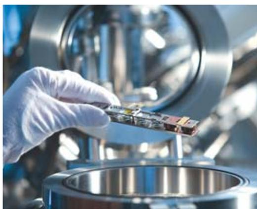
Spectroscopie de photo-électrons X (XPS) : mise en place d'un support d'échantillon dans le sas d'entrée du spectromètre.
