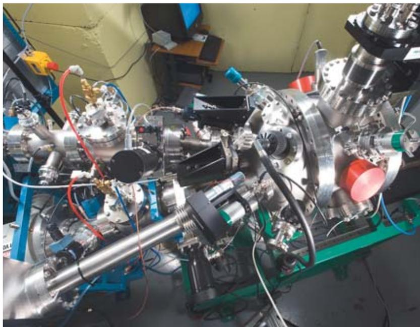
Chambre d'expériences triple-faisceau de la plateforme JANNUS à Saclay. La ligne de faisceau issue d'Épiméthée est située dans le plan horizontal à l'avant et celle provenant de Japet à l'arrière. La ligne de faisceau d'Yvette est visible dans le plan inférieur au centre. La première expérience d'irradiation en mode triple-faisceau a été conduite avec succès en mars 2010.
