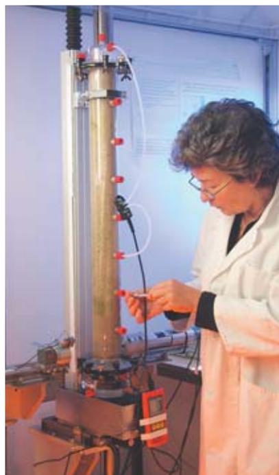
Étude de la migration des nanoparticules dans les sols pour la préservation des ressources en eau potable. La colonne de sol est placée sur un banc gamma pour enregistrer en continu la teneur en eau du sol.
