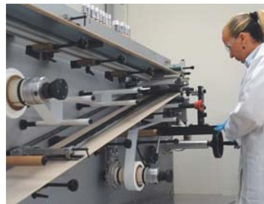
Bobinage des électrodes (positives et négatives) et séparateurs.
