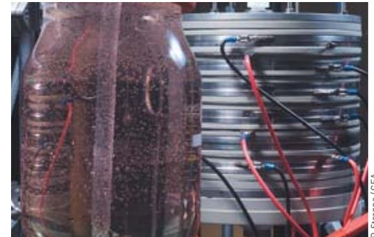
Détail du pilote de dépollution des eaux chargées en ions lourds : à droite, l'empilement de feutres actifs (qui captent les ions lourds) et de contre-électrodes (qui permettent le rinçage acide électrocommandé générant les feutres) ; à gauche, le réservoir d'eau riche en ions lourds.
