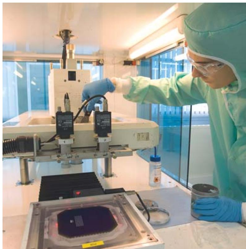
Sérigraphie des contacts métalliques d'une cellule photovoltaïque en silicium.
