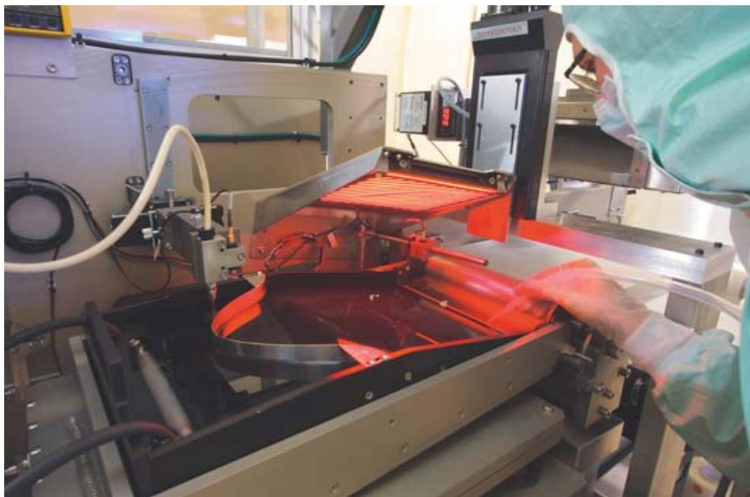
Plateforme D2M, machine de dépôt ordonné de micro ou nanoparticules opérant sur des substrats de petite ou grande dimension [de quelques cm<sup>2</sup> à quelques centaines de cm<sup>2</sup>].
