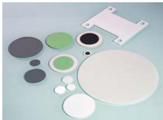
Composants EHT planaires : électrolytes, cellules à électrolyte support et cellules à électrode support.
