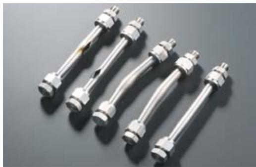
Machine d'essais d'éclatement en pression interne de gaines en conditions nominales (environ 350 °C) et vue des tronçons de gaines après test.
