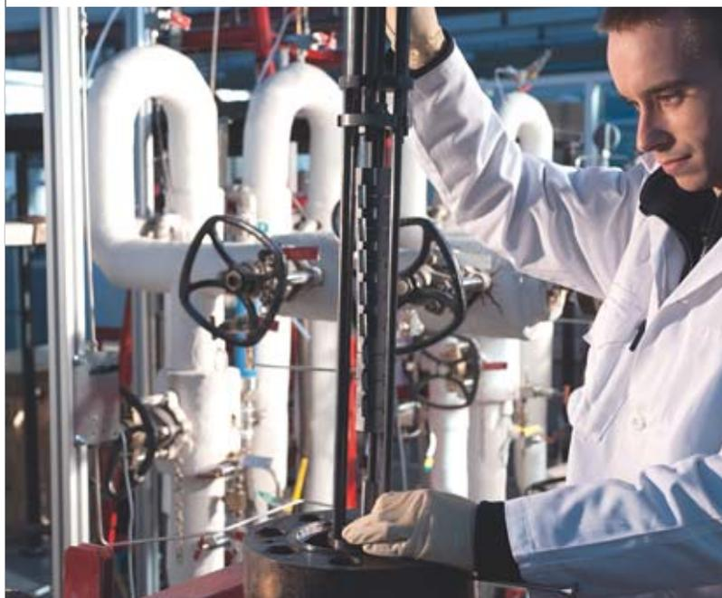
Mise en place d'échantillons de corrosion sous contrainte dans l'installation Vénus située sur le Centre de Saclay.
