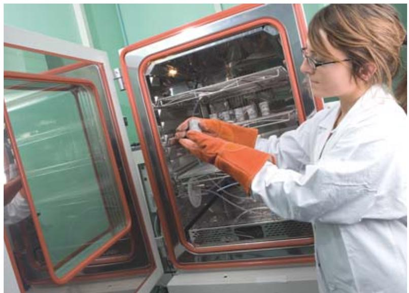
Étude de la réactivité des bétons vis-à-vis du CO<sub>2</sub> gazeux : réalisation d'un essai de carbonatation accélérée.
