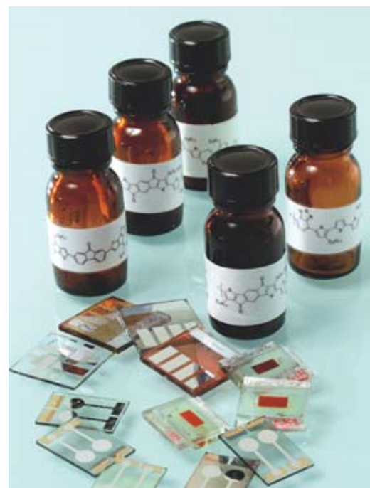
Échantillons de polymères pi-conjugués et prototypes tests de cellules photovoltaïques fabriquées à partir de ceux-ci.
