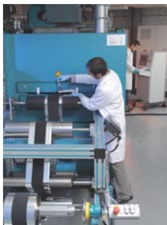
À gauche, réalisation d'électrodes composites positives par induction par voie solvant. Ce procédé implique l'élaboration d'une « encre » par dissolution d'un liant organique dans un liquide et la dispersion des particules solides (matériau actif et additifs) dans ce mélange. Cette encre est alors enduite sur le collecteur métallique, séchée et calandree pour en réduire la porosité. À droite, accumulateurs Li-ion bobinés.
