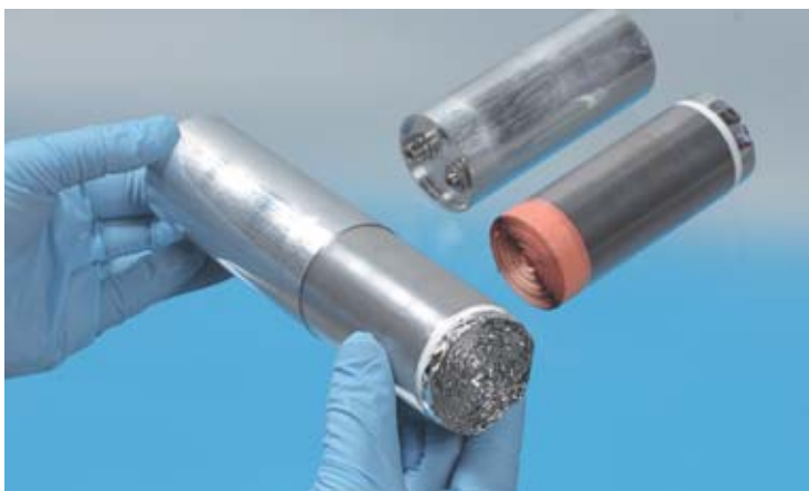
À gauche, réalisation d'électrodes composites positives par induction par voie solvant. Ce procédé implique l'élaboration d'une « encre » par dissolution d'un liant organique dans un liquide et la dispersion des particules solides (matériau actif et additifs) dans ce mélange. Cette encre est alors enduite sur le collecteur métallique, séchée et calandree pour en réduire la porosité. À droite, accumulateurs Li-ion bobinés.
