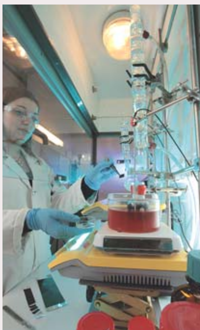
Lixiviation de composants de batteries Li-ion.
