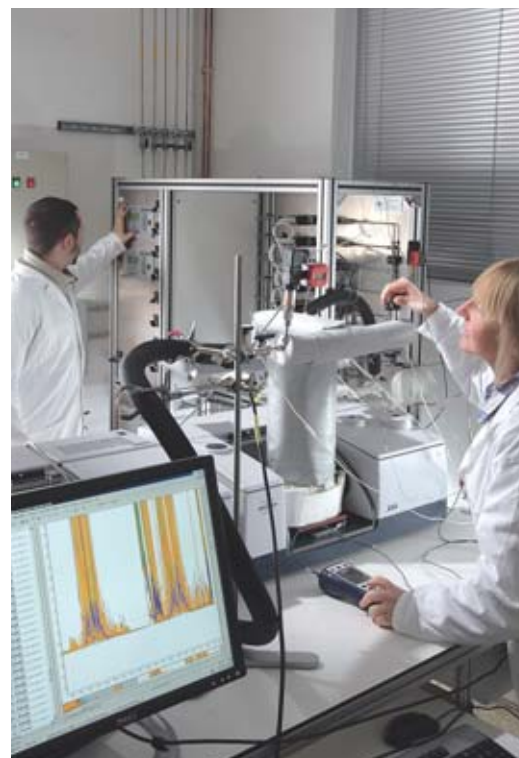
Installation d'analyse par spectroscopie infrarouge à transformée de Fourier (IRTF) permettant de mesurer les teneurs en composés inorganiques et les goudrons à l'état de traces dans le gaz de synthèse.
