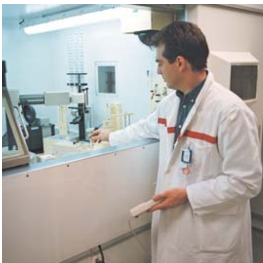
Mise en place des produits dans la cellule blindée du robot Zymate XP (USA) réalisée au Service hospitalier Frédéric-Joliot.
