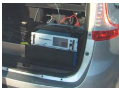
Appareil embarqué de CRDS (pour Cavity Ring Down Spectroscopy ), dédié à l'analyse in situ de polluants gazeux. Il s'agit d'un système développé par le Département de physico-chimie (DPC) situé sur le centre du CEA de Saclay, en collaboration avec l'université Joseph Fourier de Grenoble.
