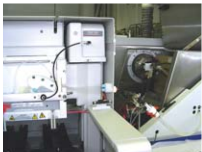
Couplage d'un appareil d'électrophorèse capillaire EC (à gauche) avec l'ICPMS (pour Inductively Coupled Plasma Mass Spectrometry /à droite).
