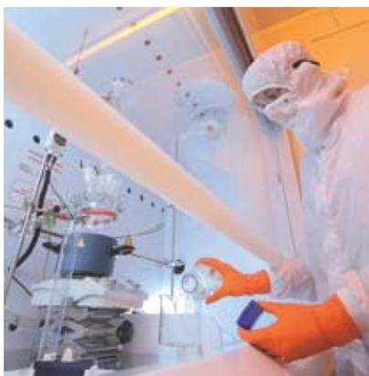
Modification de surface en salle blanche par silanisation en phase liquide sur support solide.
