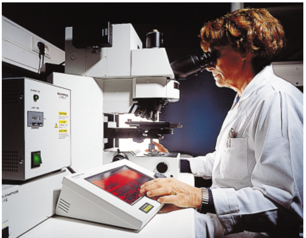
● ● ● ● ● Microscope à fluorescence utilisé au CEA/Fontenay-aux-Roses pour la technique du painting ("peinture") des chromosomes.
