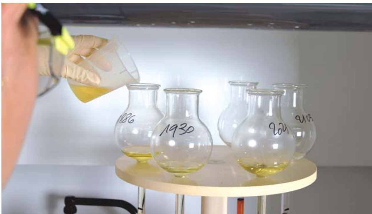
Préparation d'échantillons pour une analyse radiologique. Traitement d'échantillons environnementaux : chromatographie en vue de l'extraction de radionucléides .
