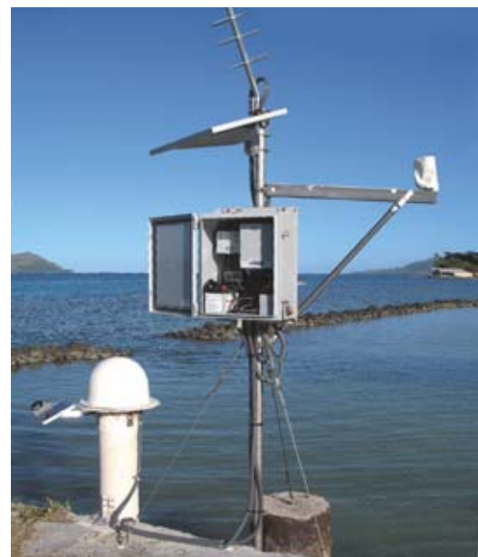
Vue du marégraphe de Rikitea (îles Gambier, Polynésie française), appareil servant à enregistrer les variations du niveau de l'océan. Le dispositif d'acquisition et de transmission est placé suffisamment haut par rapport à l'océan, en cas de vagues très élevées.
