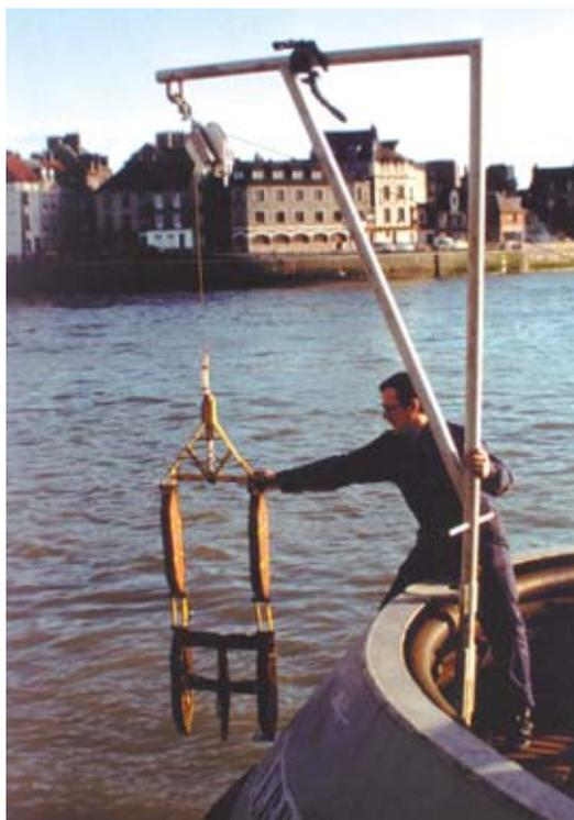
Mise à l'eau d'un traîneau de détection de radiotraceurs pour la mesure du charriage de sable en zone littorale.
