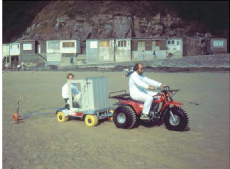
Détection de radiotraceurs sur grand estran découvrant sur la côte ouest du Cotentin.
