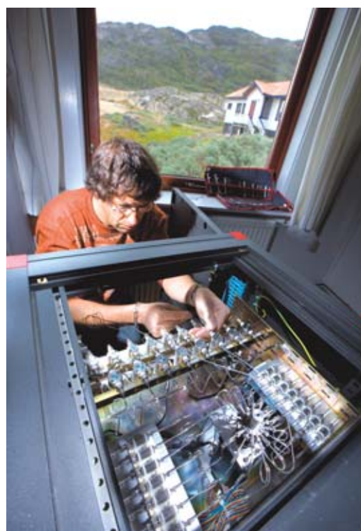
Connexion des dernières lignes (air et standard de calibration) sur le Caribou, instrument de mesure en continu du CO 2 .
