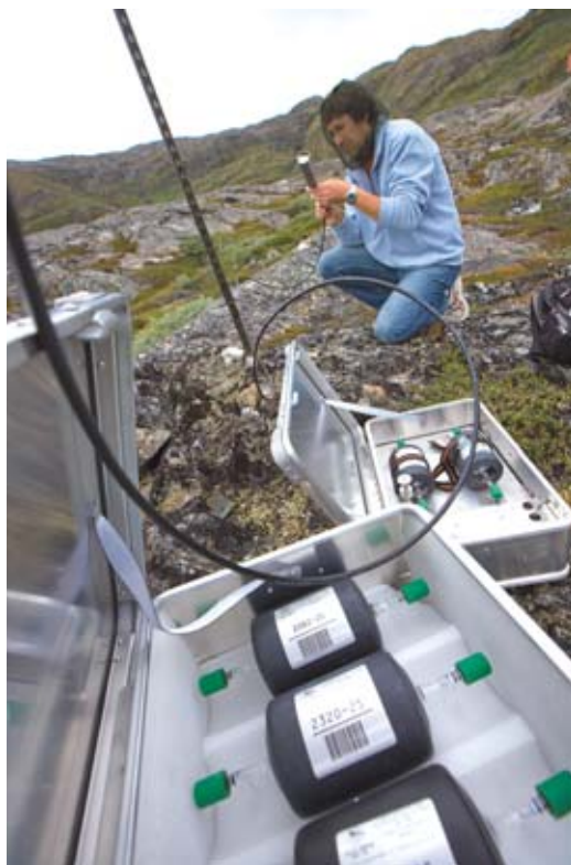
Vérification de la tête de prélèvement, avant les tests, de la mallette de prélèvement de flacons, sur le site d'Ivittuut (côte Ouest du Groenland). Au premier plan les flacons de prélèvement.
