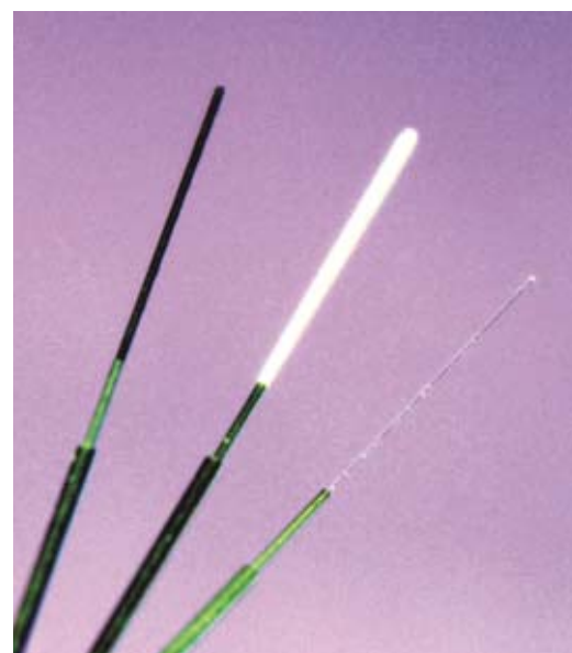
Fibre de micro-extraction en phase solide permettant l'absorption directe des substances présentes dans l'eau ou dans l'air avant leur analyse chimique, notamment par chromatographie en phase liquide ou gazeuse.
