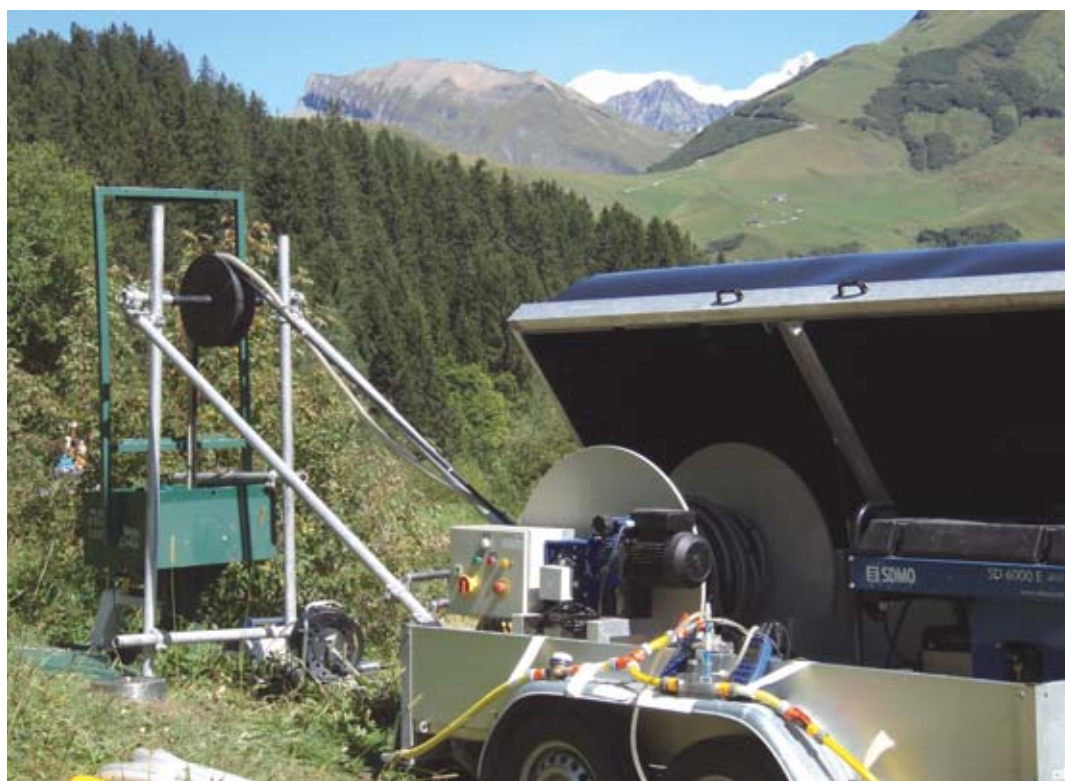
Dispositif de prélèvement des eaux souterraines dans un puits sur la station expérimentale de Roselend (Savoie), avec suivi en continu des paramètres physico-chimiques, des volumes pompés et du niveau piézométrique.
