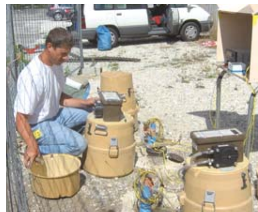
Mise en œuvre de traçage sur le terrain : enregistrement du signal de fluorescence dans les piézomètres.
