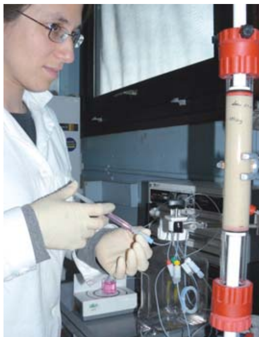
Injection de nanotraceurs fluorescents dans une colonne de sol.
