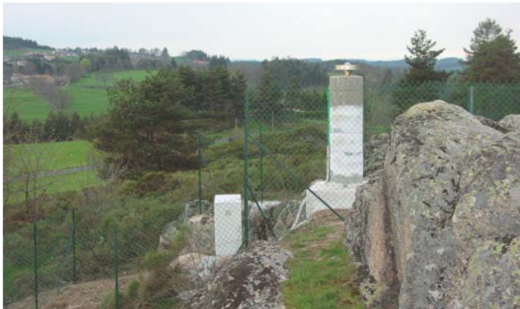
Station GPS permanente TENC (Tence, Auvergne) installée par le Dase pour la surveillance de la faille des Cévennes.
