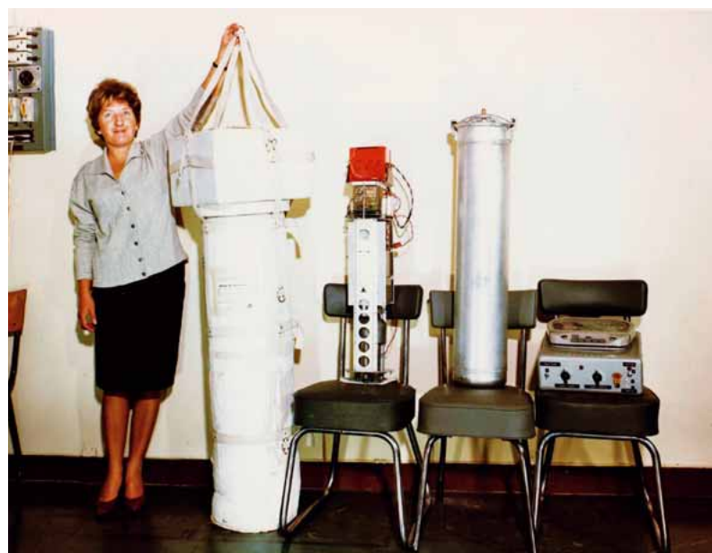
Charge portée par le ballon : détecteurs protégés du vide dans une cocotte-minute étanche et données enregistrées sur un magnétophone à bande récupéré après le vol (mai 1965).
