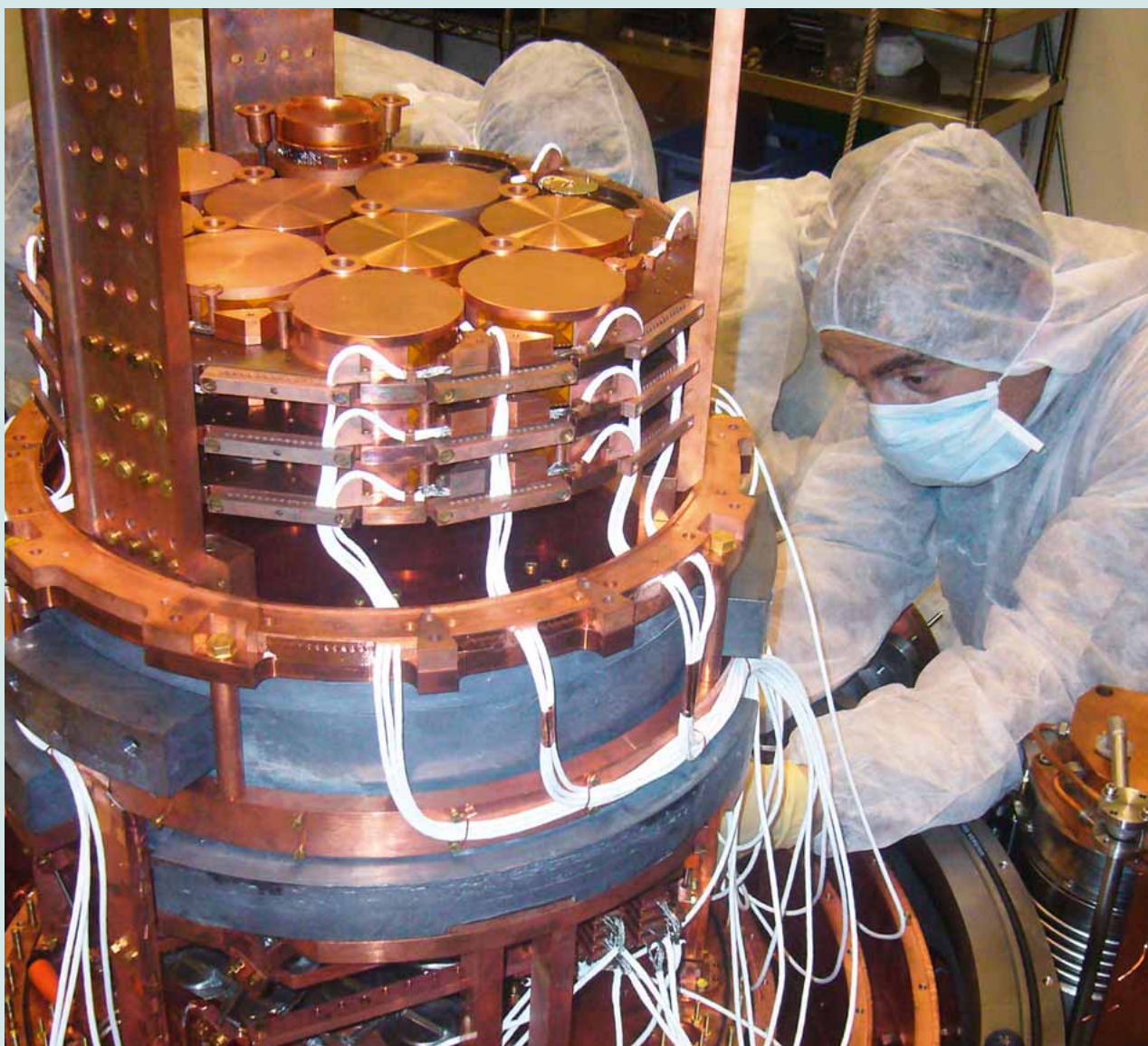
Le cryostat d'Edelweiss ouvert pendant le montage du détecteur.
