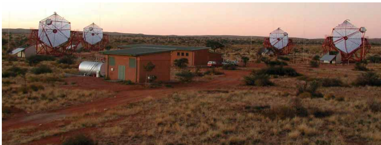
Les quatre télescopes de 12 m de diamètre de la phase 1 de HESS, installés en Namibie.
