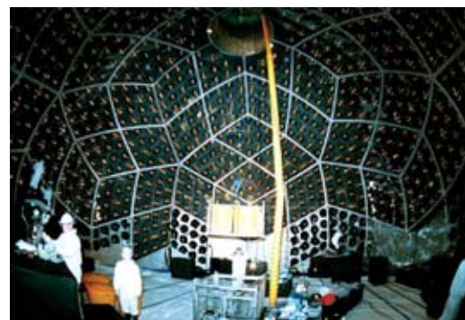
Maquette (en haut) de l'ensemble du détecteur de l'expérience KamLAND. En bas, vue de l'intérieur du détecteur durant l'installation des tubes photomultiplicateurs.
