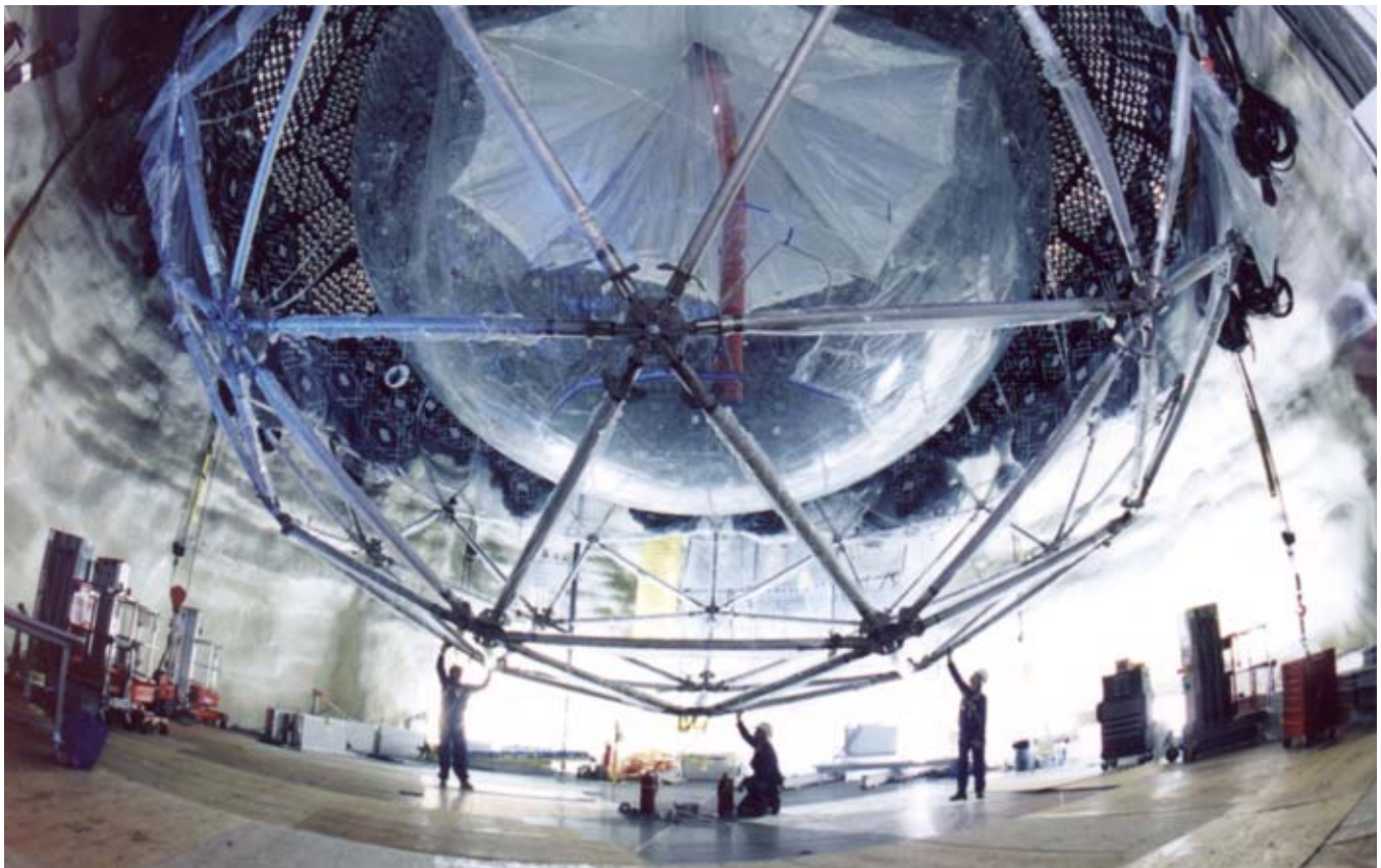
Vue lors de sa construction de la cible de l'Observatoire de neutrinos de Sudbury (SNO) qui est composée de 1 000 tonnes d'eau lourde enfermées dans un récipient de plastique acrylique. Ce volume est observé par 9 600 détecteurs portés par la structure métallique.
