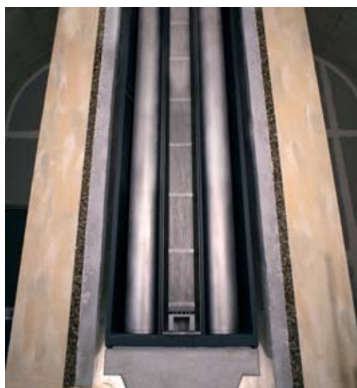
Coupe d'un puits d'entreposage expérimental de combustible usé dans la galerie Galatée, construite au centre CEA de Marcoule, pour étudier le comportement des éléments d'une installation d'entreposage de longue durée de déchets en subsurface. Dans cette formule d'entreposage comme dans les autres étudiées, l'objectif ultime reste de retarder, pendant le temps nécessaire à la disparition effective de leur radioactivité, toute dispersion de radionucléides dans la biosphère.
