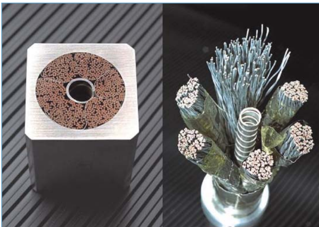
Figure 4. À gauche, le CICC de la bobine modèle du solénoïde central d'ITER (51 mm x 51 mm, 40 kA); à droite, vue explosée du CICC de la bobine modèle du système TF d'ITER (diamètre 40,7 mm, 80 kA).
