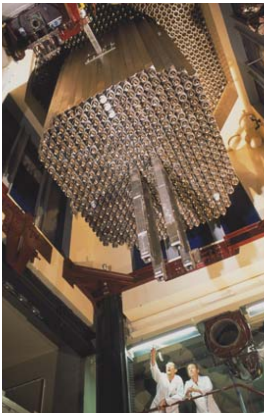
Le réacteur Masurca, situé à Cadarache, vu de dessous. Les pistes d'innovation proposées pour la conception des cœurs de RNR-Na du futur déboucheront sur des programmes expérimentaux de R&D dans des maquettes critiques, dont Masurca.
