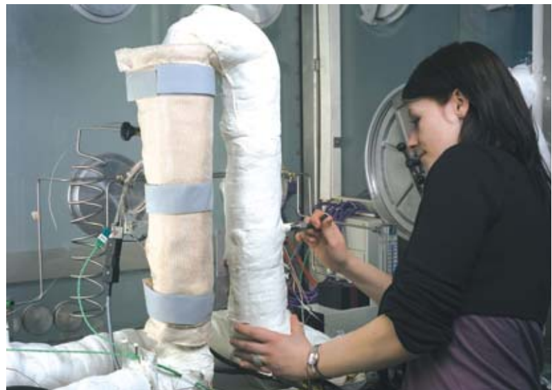
Optimisation du procédé de purification d'hélium sur le réacteur chimique CIGNE. La qualité de l'hélium est très importante, car les impuretés de ce gaz caloporteur conditionnent son pouvoir corrosif sur les matériaux de structure.
