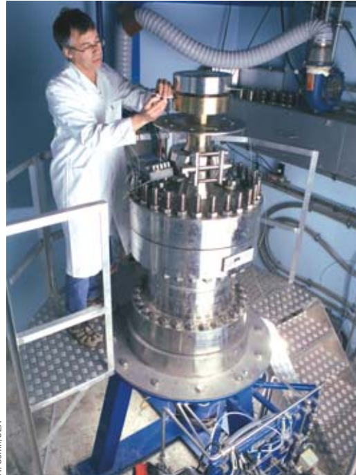
Le banc HETIQ ( HElium Tightness Qualification ), installé sur le Centre de Cadarache, a été mis au point pour tester et qualifier tous les dispositifs d'étanchéité susceptibles d'être rencontrés dans un RNR-G, dans des conditions représentatives.
