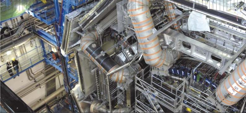
Vue d'Atlas, l'un des détecteurs installés auprès du LHC, le grand collisionneur de hadrons qui entre en service en 2008 au Cern, près de Genève. Quatre des huit aimants toroïdaux à bobines supraconductrices de l'installation sont partiellement visibles. Le CEA participe à la conception de ce détecteur, ainsi qu'à celle du CMS.
