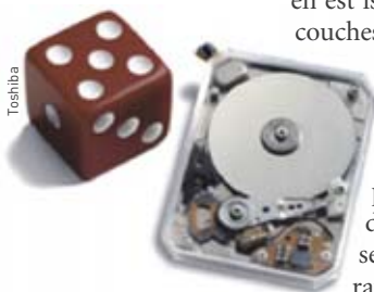
Figure 3. Disque Toshiba de 2 cm de diamètre avec une capacité de 4 Go pour un poids plume de 8,5 g!
