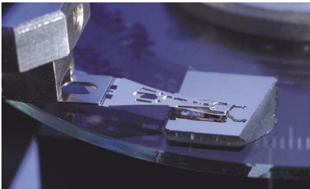
Tête de lecture-écriture du banc testeur quasi-statique.
