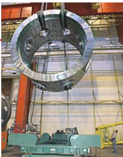
Virole porte-tubulure de la cuve destinée au réacteur Flamanville 3 d'EDF, le premier EPR devant être construit sur le sol français.
