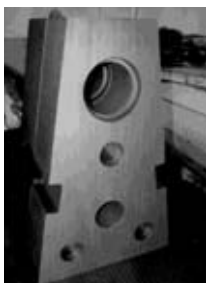
Blocs de graphite de l'empilement du réacteur à haute température japonais HTRR (en haut) et blocs réflecteurs du réacteur à haute température chinois HTR-10 (en bas).
