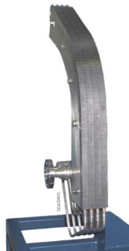
Composite carbone/carbone (C/C) employé dans la machine de fusion Tore Supra comme première paroi face au plasma (l'élément mesure 1 m).
