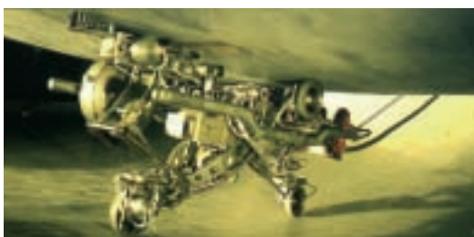
Le robot d'inspection MIR pour le contrôle des soudures de la cuve principale du réacteur Superphénix, ici dans l'espace compris entre cette cuve et la cuve de sécurité.
