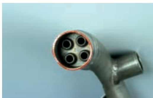
H-mètre pour la détection de l'hydrogène. L'hydrogène éventuellement contenu dans le sodium qui circule dans les quatre tubes en nickel diffuse à travers ce métal et se retrouve dans l'espace sous vide autour des tubes où un spectromètre mesure sa concentration.
