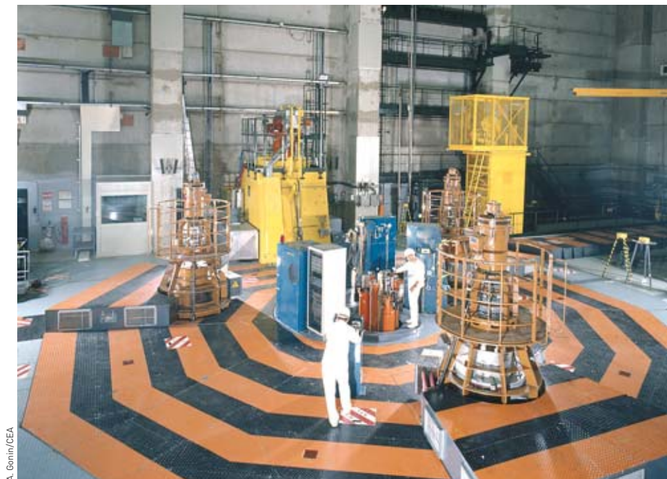
Figure 1. Dispositif d'irradiation. Les aiguilles ou les composants internes renfermant les combustibles ou les matériaux à tester sont introduits et positionnés dans la capsule expérimentale. La capsule est ensuite verrouillée dans son porteur.
