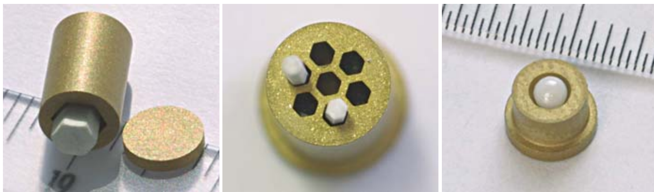
Concepts de combustibles innovants pour les RNR-G, étudiés dans le cadre de l'expérience Futurix-Concepts.
