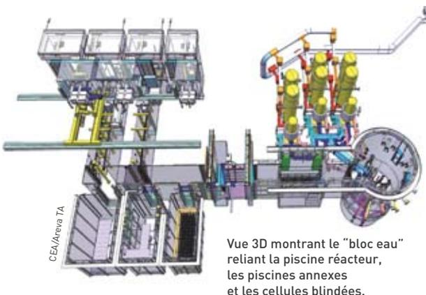
Vue 3D montrant le "bloc eau" reliant la piscine réacteur, les piscines annexes et les cellules blindées.
