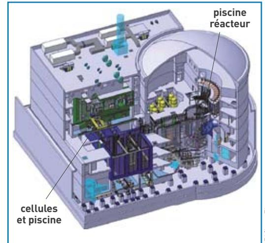
Coupe du bâtiment réacteur du RJH faisant notamment apparaître les supports antisismiques (en bas) et la piscine (à droite).
