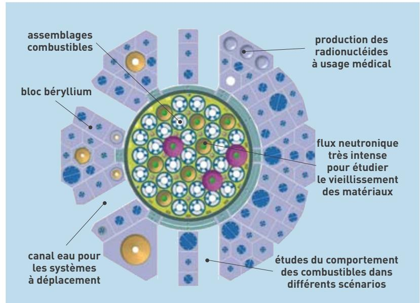
Figure 1. Configuration typique du cœur du RJH chargé d'une vingtaine d'expériences tout en permettant la production simultanée de radio-isotopes à usage médical.
