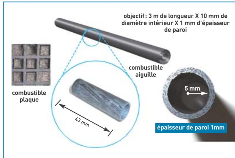
Figure 2. Gainage en SiC/SiC pour combustible de RNR-G (concepts plaque et aiguille).
