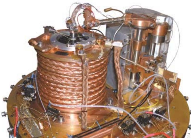
L'un des derniers prototypes de réfrigérateur développés par le laboratoire, capables de produire 48 mK.
