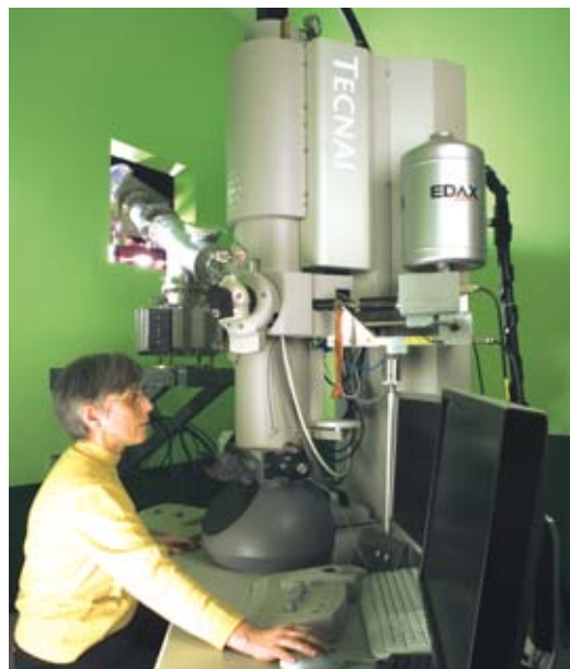
Le nouveau microscope électronique en transmission du CSNSM permettra d'observer l'évolution de la microstructure d'un échantillon au cours de son irradiation simultanée par deux faisceaux d'ions. La colonne du microscope va recevoir deux lignes de faisceaux d'ions énergétiques, orientées symétriquement l'une par rapport à l'autre. La ligne provenant de l'accélérateur Aramis est visible. La seconde ligne issue de l'implanteur Irma est en cours de fabrication.
