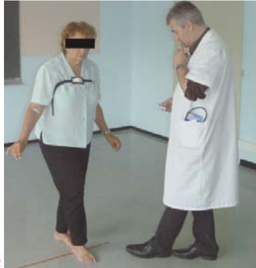
Diagnostic clinique d'analyse d'activité pour une personne âgée. Les mouvements sont enregistrés avec une micro-centrale d'attitude placée sur le thorax.
