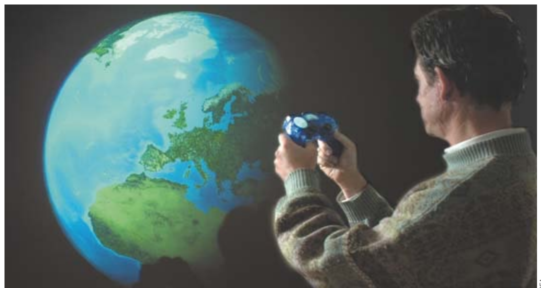
Interface avec une base de données 3D de l'IGN. La navigation est fonction de l'orientation donnée à la manette dans l'espace.
