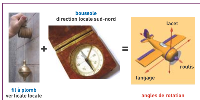
Figure 1. Principe de l'évaluation des angles de rotation dans un repère tridimensionnel, à partir d'informations de type mesures de verticalité et de rotation par rapport au nord magnétique.
