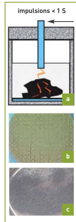
Figure 2. Schéma de principe de déstructuration par courants pulsés émis par un générateur de Marx sous une tension de 200 à 500 kV et avec une intensité de 10 à 20 kA (a), et vue d'une structure alvéolaire SiC remplie de SiC (combustible dispersé) avant traitement par courants pulsés (b) et après 30 impulsions (c).
