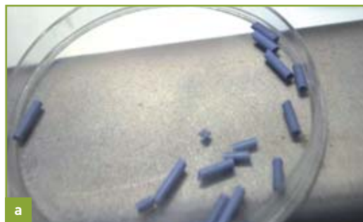
Figure 8. a) Vue du sel avant contact (couleur bleue caractéristique du Pu(III)). b) Du sel après contact (couleur marron caractéristique des lanthanides), après extraction des actinides.
