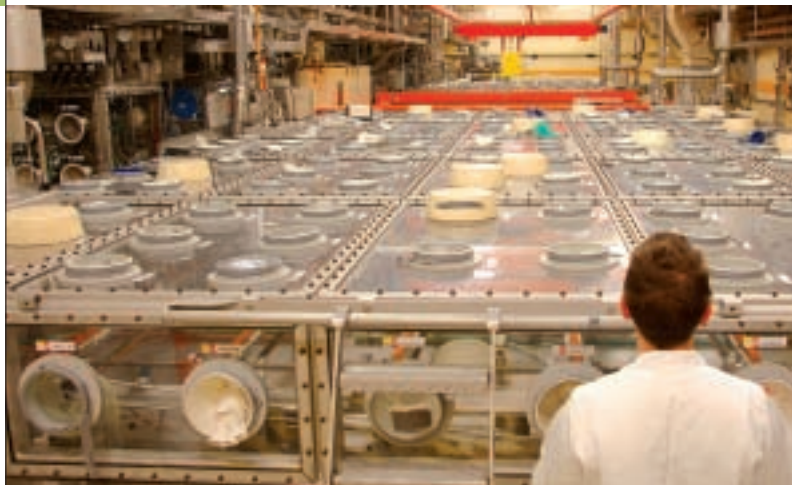
Boîtes à gants de gainage des crayons MOX dans l'usine Melox de Bagnols-sur-Cèze (Gard).
