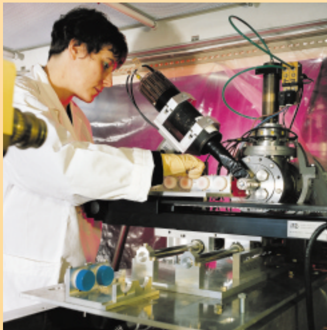
CEA Rayonnement alpha. Sur la ligne de faisceau de l'accélérateur tandem de 7 MV utilisé pour des irradiations de cellules en culture au Laboratoire de radiotoxicologie du CEA à Bruyères-le-Châtel, la gamme d'énergie, de 2 à 15 MeV, autorise des débits de dose de 0,1 à plus de 300 Gy/mn. Par ailleurs, des sources d'actinides, plutonium 239 ou américium 241, couvrent une gamme d'énergie de 4 à 5 MeV avec des débits de dose de 0,05 et 0,2 Gy/mn respectivement.
